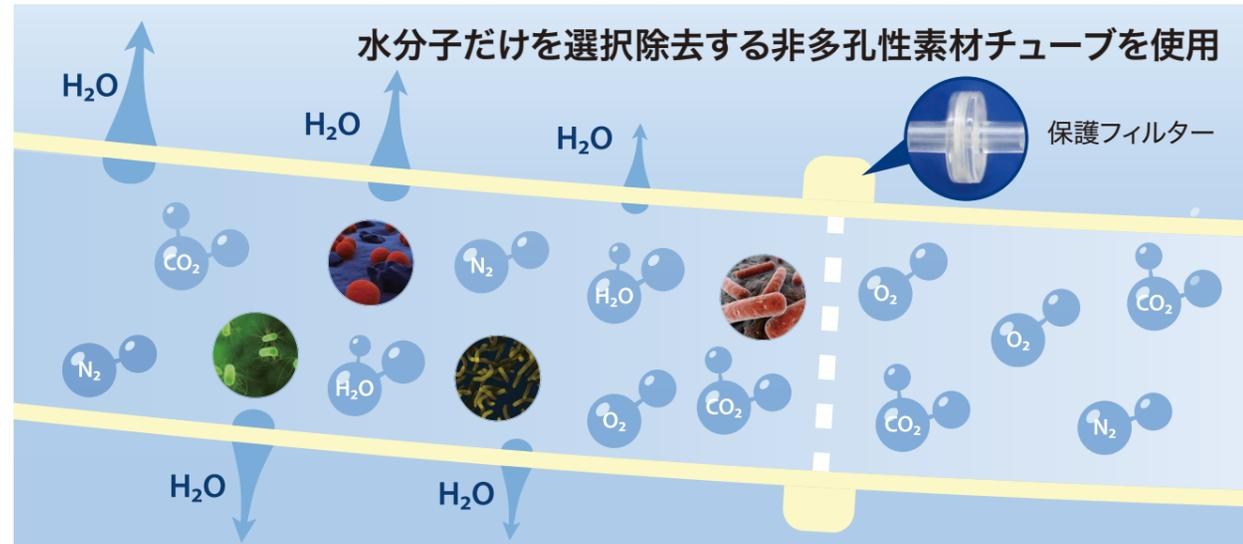
BPカプノカニューラのLシリーズはサンプリングチューブとして水分を透過して大気に排出する新開発の非多孔性素材を使用しています。従来から同じ目的に使用されているNafion®に比べて、安価でチューブ全部に使用しておりほぼ完全に水分を除去できます。従って水分除去用のウォータートラップを挿入する必要がなく、機器の汚染を防ぐために死腔負担の少ない保護フィルタのみが付加されています。従って、サンプリングガス系の死腔は最小限で、新生児や小児の速く小さい呼吸に対しても充分な分解能が確保されて、歪の少ない真値に近いCO<sub>2</sub>波形で正確なEtCO<sub>2</sub>値が得られることとなります。
