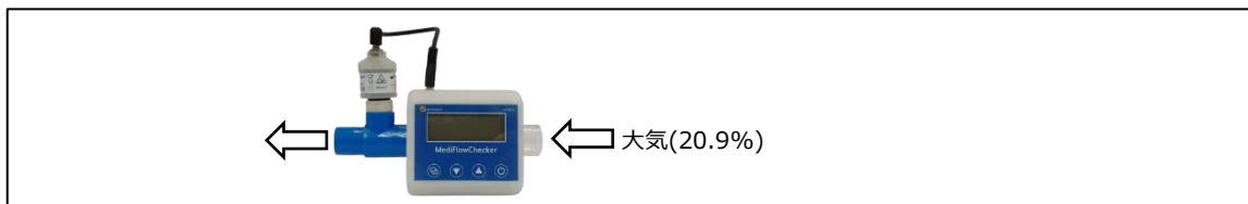
60%以下の酸素濃度を測る場合のキャリブレーションモード時の接続
